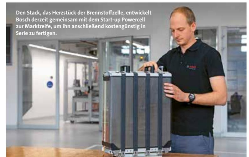
Den Stack, das Herzstück der Brennstoffzelle, entwickelt Bosch derzeit gemeinsam mit dem Start-up Powercell zur Marktreife, um ihn anschließend kostengünstig in Serie zu fertigen.
