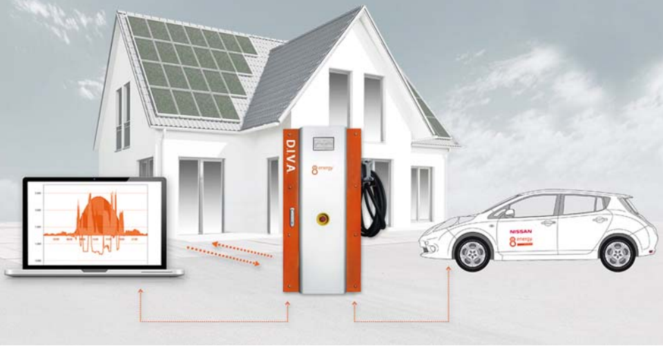
Energiemanagementsystem DIVA mit integriertem Speicher, Wechselrichter und bidirektionaler DC-Schnellladebox. Grafik: e8energy GmbH
