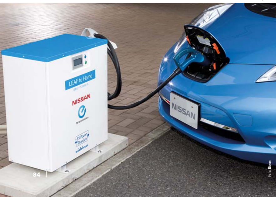
Ladevorgang eines Nissan Leaf an einer bidirektionalen Ladebox in Japan
