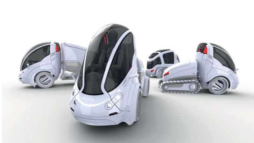
Die Konzeptstudie „Citi.Transmitter“ des Industriedesigners Vincent Chan basiert auf einem modularen Fahrzeugkonzept. In dem zweirädrigen Fahrzeug findet eine Person Platz. Abhängig von Platzbedarf oder Einsatzzweck können unterschiedliche Module angehängt werden.
