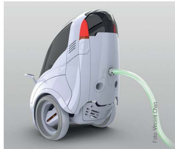
Die Konzeptstudie „Citi.Transmitter“ des Industriedesigners Vincent Chan basiert auf einem modularen Fahrzeugkonzept. In dem zweirädrigen Fahrzeug findet eine Person Platz. Abhängig von Platzbedarf oder Einsatzzweck können unterschiedliche Module angehängt werden.
