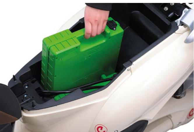
Die Wechselakkus befinden sich, wie bei fast allen E-Rollern, unter der Sitzbank.
