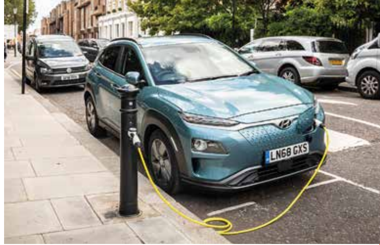
Ladepoller: eine im Straßenbild sehr unauffällige Lademöglichkeit, die allerdings eine zusätzliche Elektroinstallation erfordert (Quelle: Ubitech)
